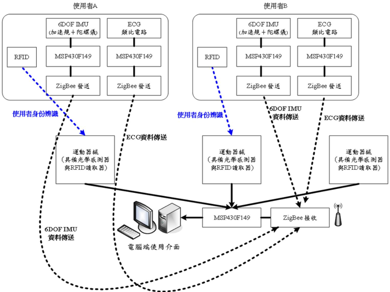
圖為預計自行開發無線型多人運動強度監測系統
